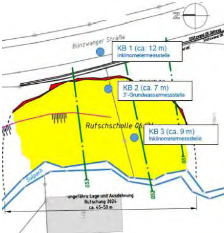
Lageplan HuP mit Rutschscholle und Anordnung der Kernbohrungen
